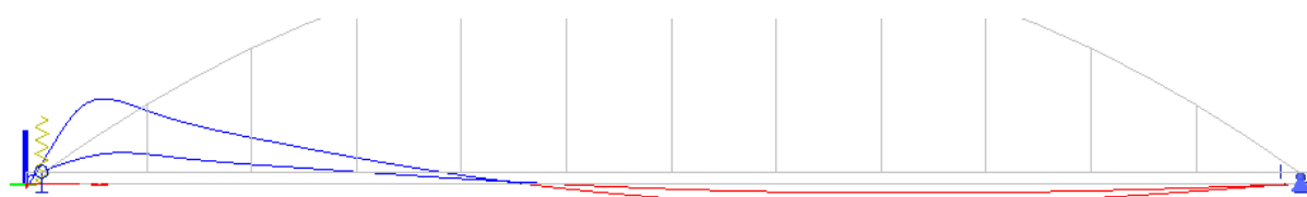
Obr.23 Vplyvová plocha -rezy koľaj č.1 a č.2 - V_z – v tráme na podperou
